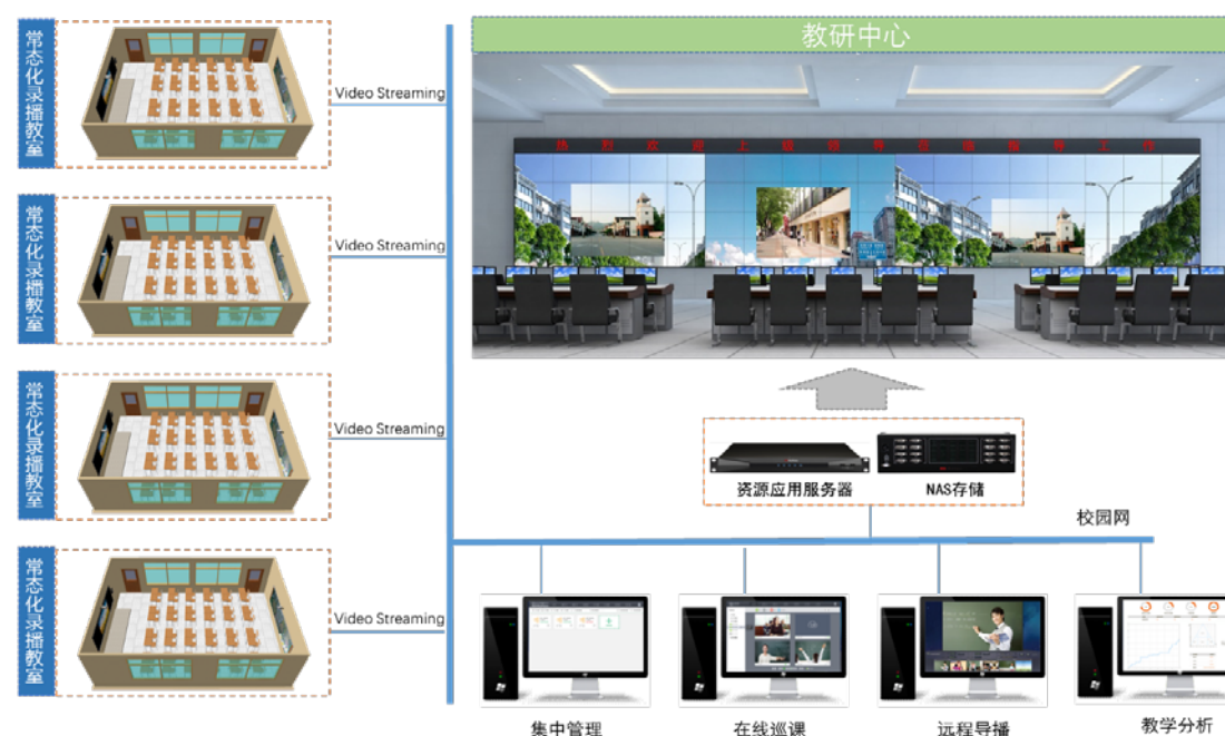
图 5-12 在线巡课系统架构图
