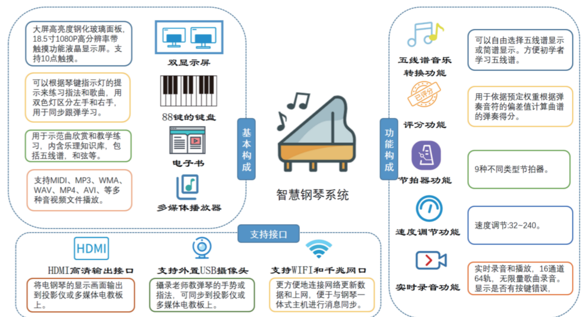
图3-34 智慧钢琴基本架构图
